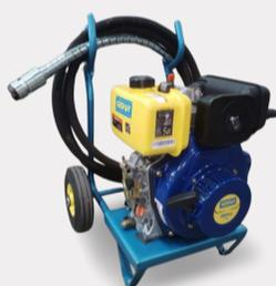
Vibrador de concreto M/Diésel 7 Hp
