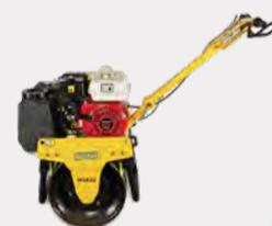
Vibrocompactador de rodillo simple m/ gasolina Honda
